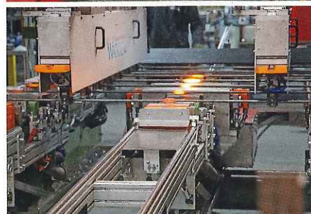
Stäbe mit Mitnehmern werden per Hand geschweißt. Im automatischen Stabcenter (unten) werden die Stäbe geformt.
