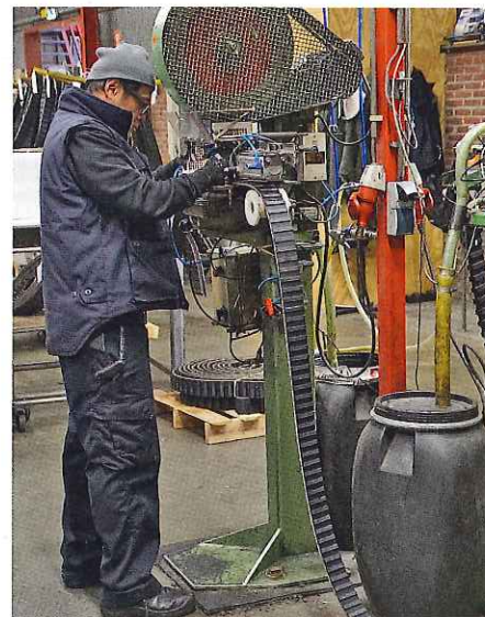
Auf dieser Maschine werden die mit Gewebe verstärkten Riemen für die Stabbänder profiliert.
