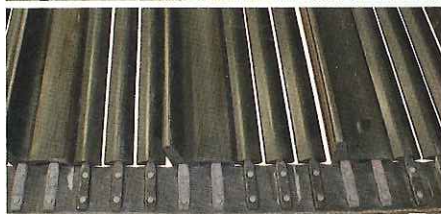
Die Bänder werden automatisch, halbautomatisch oder per Hand genietet. Auch Antriebsrollen und geschlossene Bänder gehören zur Produktpalette bei Hessels.
