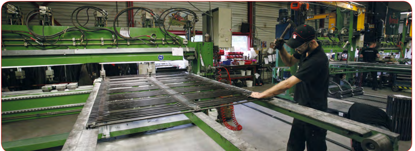
Auf der großen Nietmaschine können Bänder bis zu 3,0 m Breite und 6 Riemen automatisch genietet werden.
