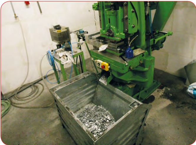
Maschine zur Herstellung von Nietplatten „Made by Hessels“.
