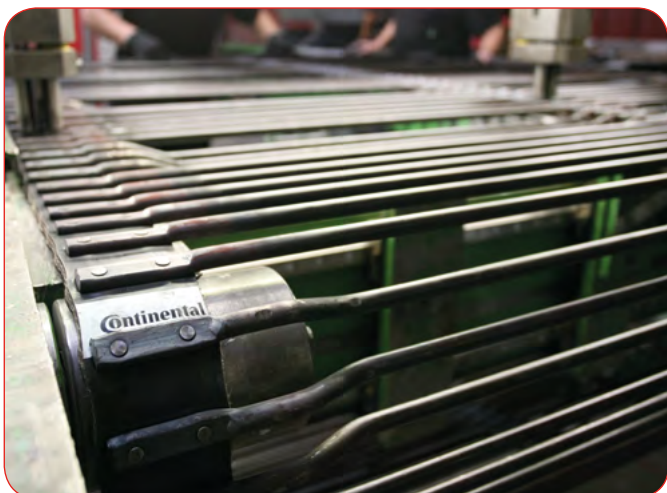
Marken-Riemen, hochwertige Nietstäbe und eine automatische Nietung garantieren die gleichbleibend hohe Qualität der Bänder.
