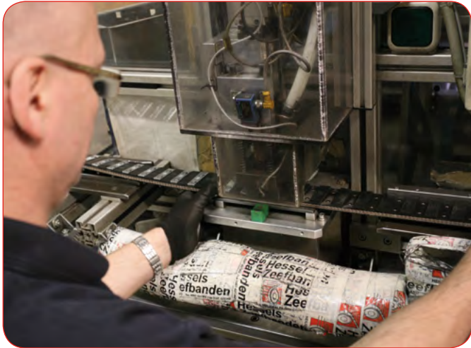
In der „Nietdrück“ – Maschine werden die fertigen Riemen mit Nietplatten und Nieten bestückt.
