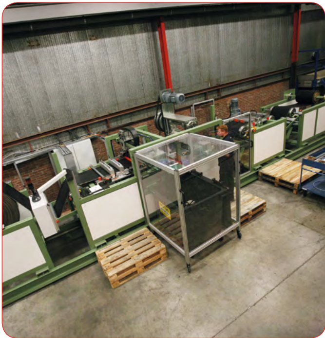
Eine zusätzliche Konfektioniermaschine wurde vor kurzem in Betrieb genommen. Sie arbeitet doppelt so schnell wie die vorhandenen und locht zusätzlich den Riemen in einem Arbeitsgang.
