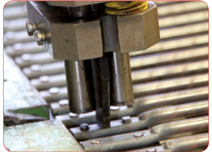
Detailaufnahme des automatischen Nietvorganges.
