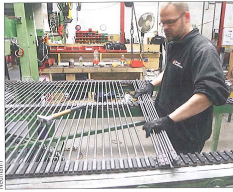
Hier werden Riemen und Nietstäbe zu Siebbändern verbunden.
