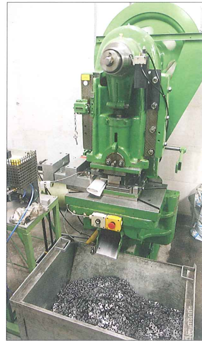
Die Stanzmaschine stellt am Tag mehrere tausend Nietplatten her.
