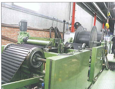
Auf den vollautomatischen Maschinen werden die Riemen konfektioniert.
