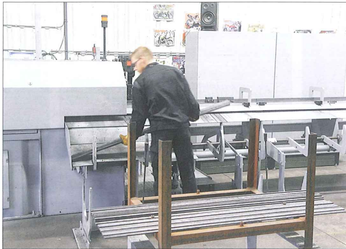
Parallel zur Riemenherstellung wird der angelieferte Stahl für die Nietstäbe geschnitten und gerichtet.
