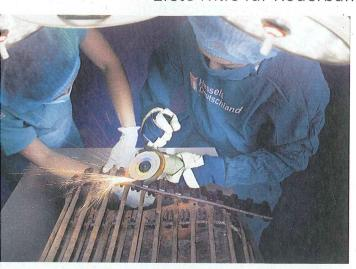
**Hessels Deutsch**land bietet jetzt einen speziellen Reparaturservice für Stabbänder und Antriebe sowie Rollen von Erntemaschinen an. Foto: Hessels
