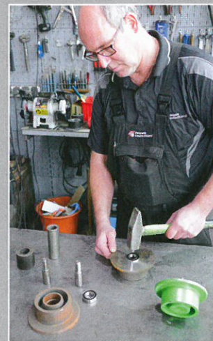
Für diese Tragrollen hat man eigene Gussformen fertigen lassen.
