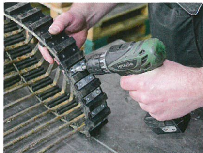
Gerettet wird, was zu retten ist. Wenn es der Verschleißgrad noch zulässt, macht es oft Sinn, ein gerissenes Band zu flicken.
