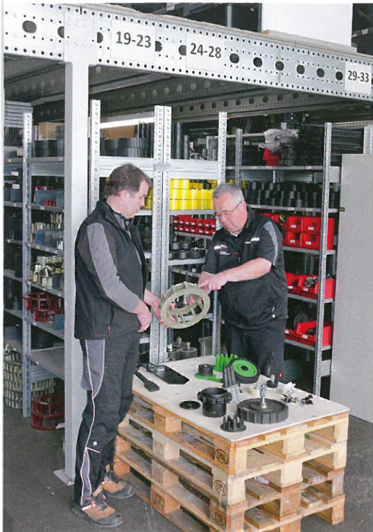
Im Reparaturfall reicht es oft nicht aus, nur ein Siebband zu tauschen. Auch die Tragrollen und Antriebsräder unterliegen hohem Verschleiß.
