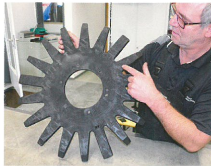
Dieser Stern ist ein typisches Verschleißteil in vielen Rübenrodern. Hessels lässt das Teil aus geeignetem Kunststoff nachfertigen.
