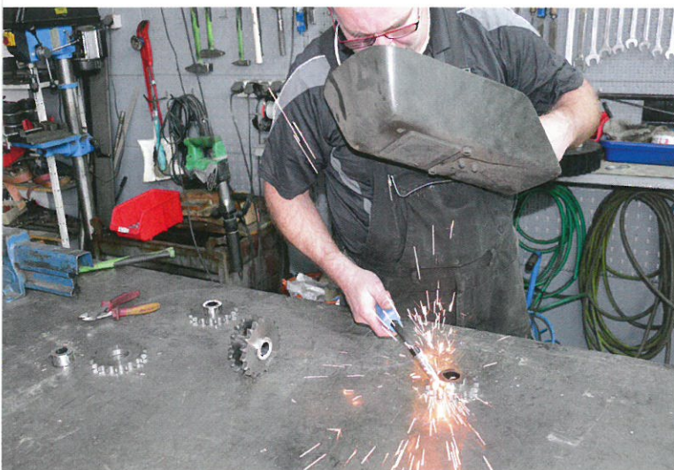
Antriebsritzel für Kettentriebe unterliegen in den Rodern oft hohem Verschleiß. Auch wenn man es auf den ersten Moment vermuten könnte, handelt es sich dabei nur selten um Standardgrößen. Aus speziell angefertigten Drehteilen werden solche Bauteile nachgefertigt.
