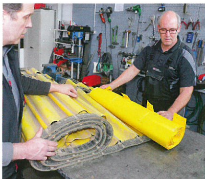
Das noch gut erhaltene Band wird seitlich geöffnet, um die Folie zu tauschen. Ein Spezialbetrieb schweißt passende Planen.
