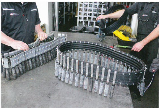
Solche Fingerbänder arbeiten in zahlreichen Rübenrodern. Die Montage aus mehreren Einzelteilen ist zeitaufwändig.
