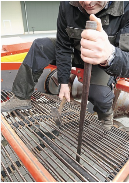
Mit einer Brechstange und einem Hammer kann es gelingen, den Stab zu richten.
