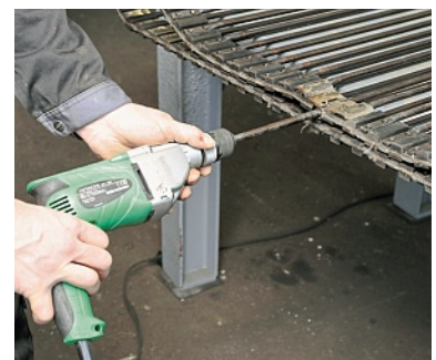
Gleichzeitig drehen und ziehen, so wird der Stab aus seinem Sitz „gelockt“.
